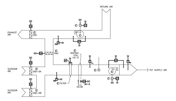
CONTROL SCHEMATIC FOR VU-5/RF-5/EF-5
